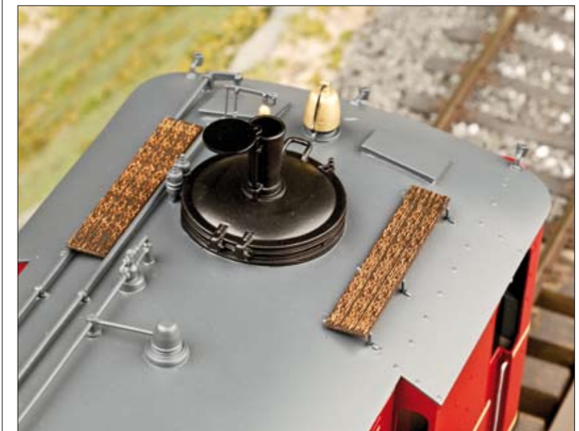
Die Dachkonstruktion des DT8 mit dem typischen Schlot (mit Deckel) und den weiteren Aufbauten
